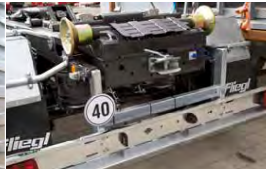
Optional: Ausziehbarer Beleuchtungsträger Bremsanschluß und Hydraulik für 2. Anhänger
