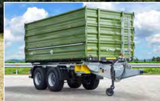
TDK 160 mit Aufbau 1800 mm (3 x 600 mm Bordwand)
