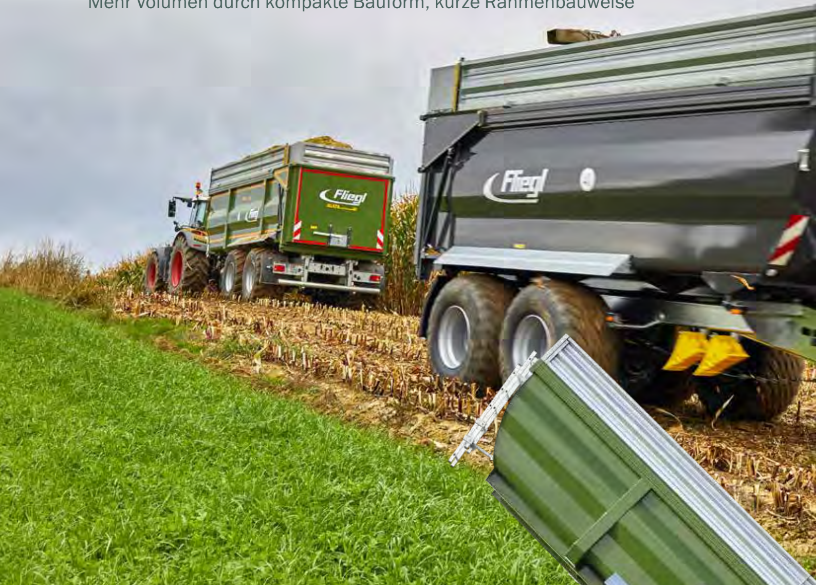
Der Tandem TMK 269 Profi mit einer Muldenlänge von 6,90 m und einem Kippwinkel von ca. 55°
