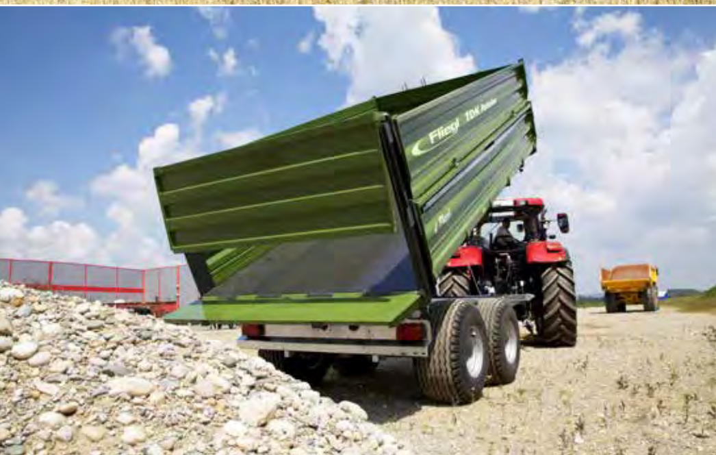
TDK 160 mit Aufbau 1800 mm (3 x 600 mm Bordwand)
