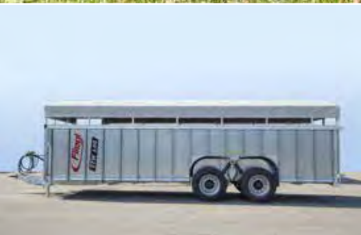
Der Tiertransportanhänger TTW 140 Tandem Noah hat eine Gesamtlänge von 8,3 m und ist perfekt geeignet für größere Tiertransporte
