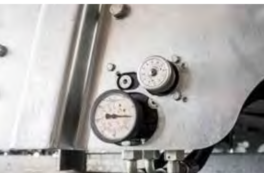
Mechanisches Potentiometer mit einstellbarer Vorschubgeschwindigkeit am Streuwerk
