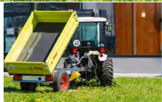
Einachs-Dreiseitenkipper für jede Schleppergröße passend
