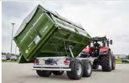
Tandem-Dreiseiten-Muldenkipper, extrem Robust durch verstärkte Seitenwand.
