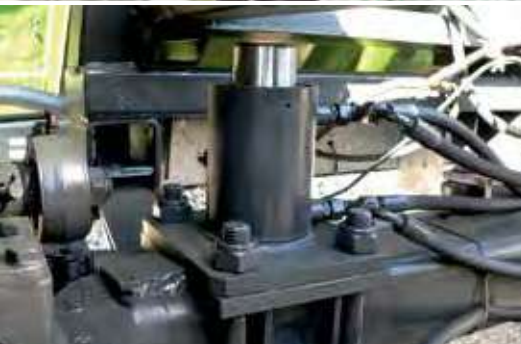
Optional: Hydraulische Abstützung auf die Achse
