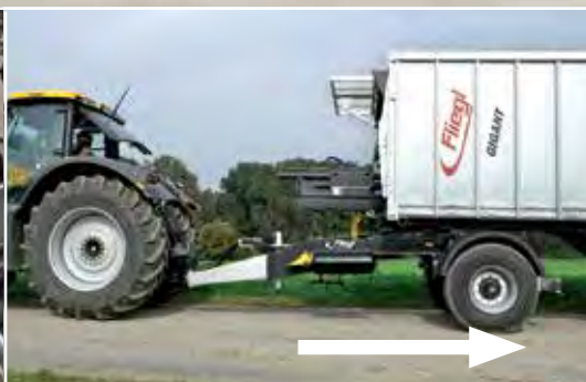
Hydraulische Sattelplattenverschiebung für Einachs- und Tandem-Dolly
