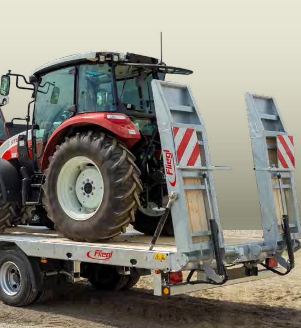
Der TPA 370 Stirnwand 800 mm in Serie Auffahrampen klappbar
