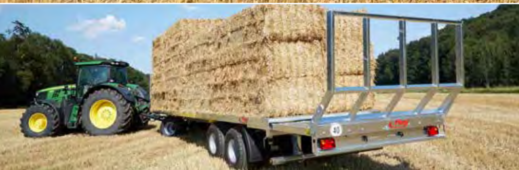
Ballengitter bei Typ DPW 180 B in Serie
