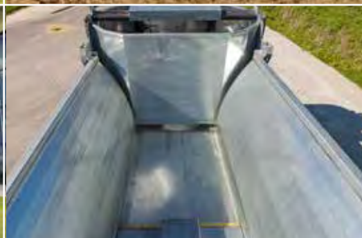
Geringster Verschleiß durch hydr. Schiebesystem – kein Kratzboden.
