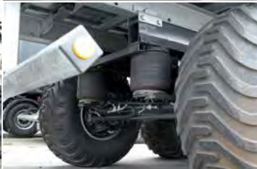
Optional: Luftfederung mit automatischer Kippabsenkung
