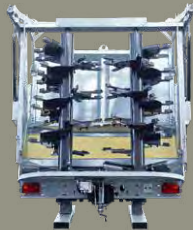
Fräswalzen mit Wurfschaufeln
