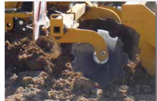
Dischiera, il sistema di dischi è regolabile per un ottimale livellamento del terreno precedentemente miscelato.
