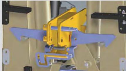
Sistema idraulico di sbloccaggio dei ganci di sicurezza
