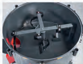
Négy rugós és állítható keverőkar a homogén keverék gyors előállításához.
