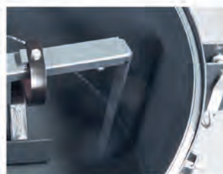
Állítható oldalfalú lehúzó a keverőtartály teljes kiürítéséhez.
