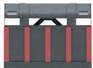
Megerősített alaptámasz menetirányba
