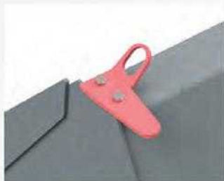
Kétoldali kijelző segítségként mikor ömlesztett árukat rakod- dik a talajról
