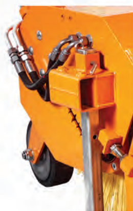
Belső olajmotor(ok) Kompakt szelep biztonsági szeleppel (a lökészelep védi a motor szabadonfutást a túlterheléstől)
