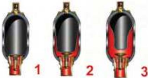
L'**accumulatore di azoto** con valvola di regolazione, permette di assorbire l'olio dei cilindri dando così la possibilità all'ancora di essere elastica e di assorbire urti e sollecitazioni con un ritorno graduale. Con questo sistema si evitano danni alla struttura del telaio.
