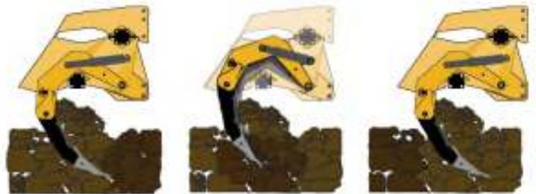
**Ancore "Craker"** indicate su terreni non sassosi ma tenaci. Il sistema idropneumatico SKAT garantisce un'ottima elasticità, quindi una maggiore durata della macchina ed una minor sollecitazione del trattore.
